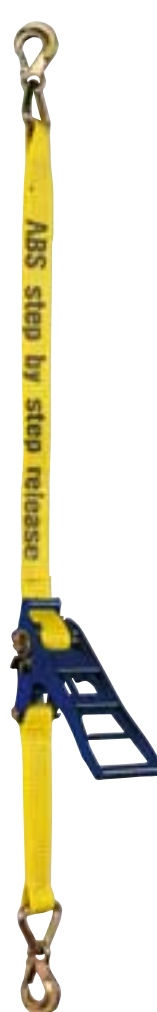
Art. ZK50 50 mm breit, gelb, mit kontrolliert lösbarer ERGO-ABS-Zugratsche, mit 2 Triangelhaken, mit Sicherung, LC 2500/5000 daN.
